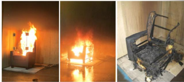
Figur 1 Brand i den autentiska fåtöljen (ögonblicket innan en boendesprinkler med 3 mm, 68°C glasbulb aktiveras; två minuter efter aktiveringen och efter försöket. Vattenflödet var 30,3 liter/min. Foto: Magnus Arvidson, Fire Research.
