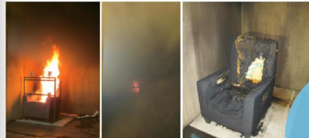
Figur 3 Brand i den autentiska fåtöljen (ögonblicket innan ett vattendimmunestycke med 3 mm, 57°C glasbulb aktiveras; två minuter efter aktiveringen och efter försöket. Vattenflödet var 32 liter/min vid 5,2 bar. Foto: Magnus Arvidson, Fire Research.
